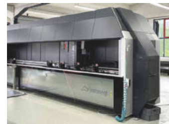
/ Das neue CNC-Bearbeitungszentrum Comet R6 HP der Firma Emmegi.
