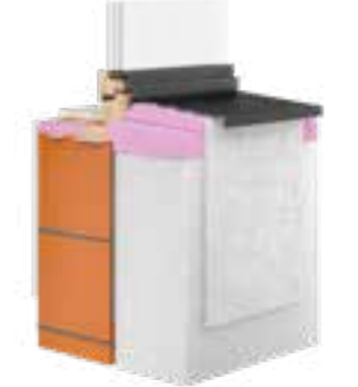
Ziegelmauerwerk mit WDVS verputzt
