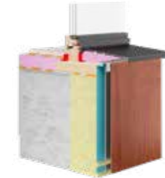
Stahlbetonwand mit WDVS und hinterlüfteter Fassade
