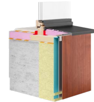
Stahlbetonwand mit WDVS und hinterlüfteter Fassade
