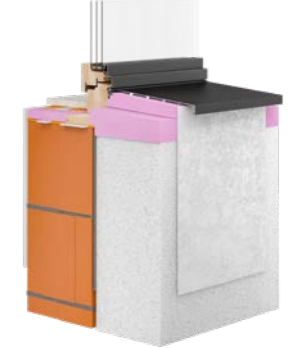
Ziegelmauerwerk mit WDVS verputzt
