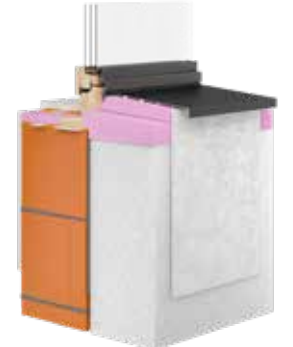
Ziegelmauerwerk mit WDVS verputzt
